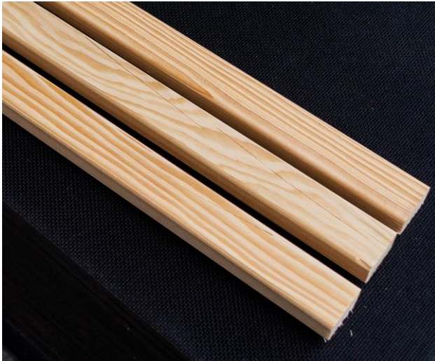
Kleine Risse, die nicht die Funktion der Holzleiste beeinträchtigen
